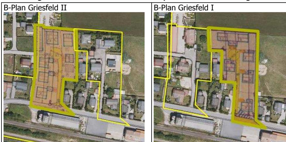
Für die Berechnung wurden jeweils Flächenschallquellen auf die Teilflächen gelegt, so dass unter Berücksichtigung von Boden und Abschirmwirkungen und Reflexionen die zulässigen Orientierungswerte eingehalten werden können. In der Nacht wird der flächenbezogene Schalleistungspegel entsprechend den geringeren Orientierungswerten der DIN 18005-1 bzw. den Immissionsrichtwerten der TA Lärm /5/ um 15 dB(A) reduziert.
