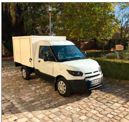
Neuer Zugang im Bauhof-Fuhrpark: Der Streetscooter, geleast für vier Jahre, wird vor allem von den Elektrikern genutzt. Die 20kWh-Batterie reicht ca. 100 Kilometer, die Höchstgeschwindigkeit beträgt 85 km/h.
