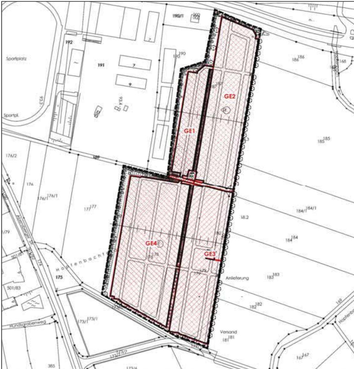
Abbildung 9: Darstellung der Bauquartiere und der Emissionsbezugsflächen (M 1:3.000)
